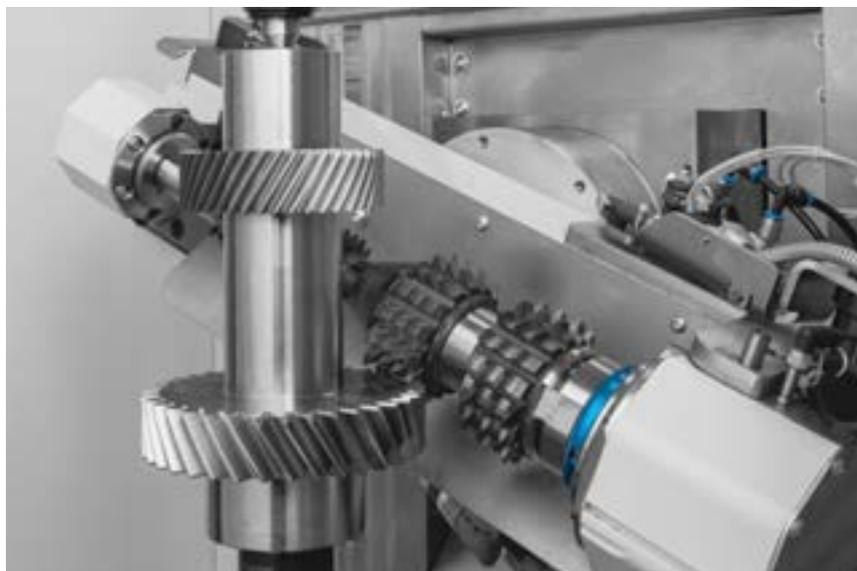
可选带有外侧支架的倒角滚刀头，最多容纳四个倒角滚刀，用于一根轴上的两个齿轮或非标准齿轮。
