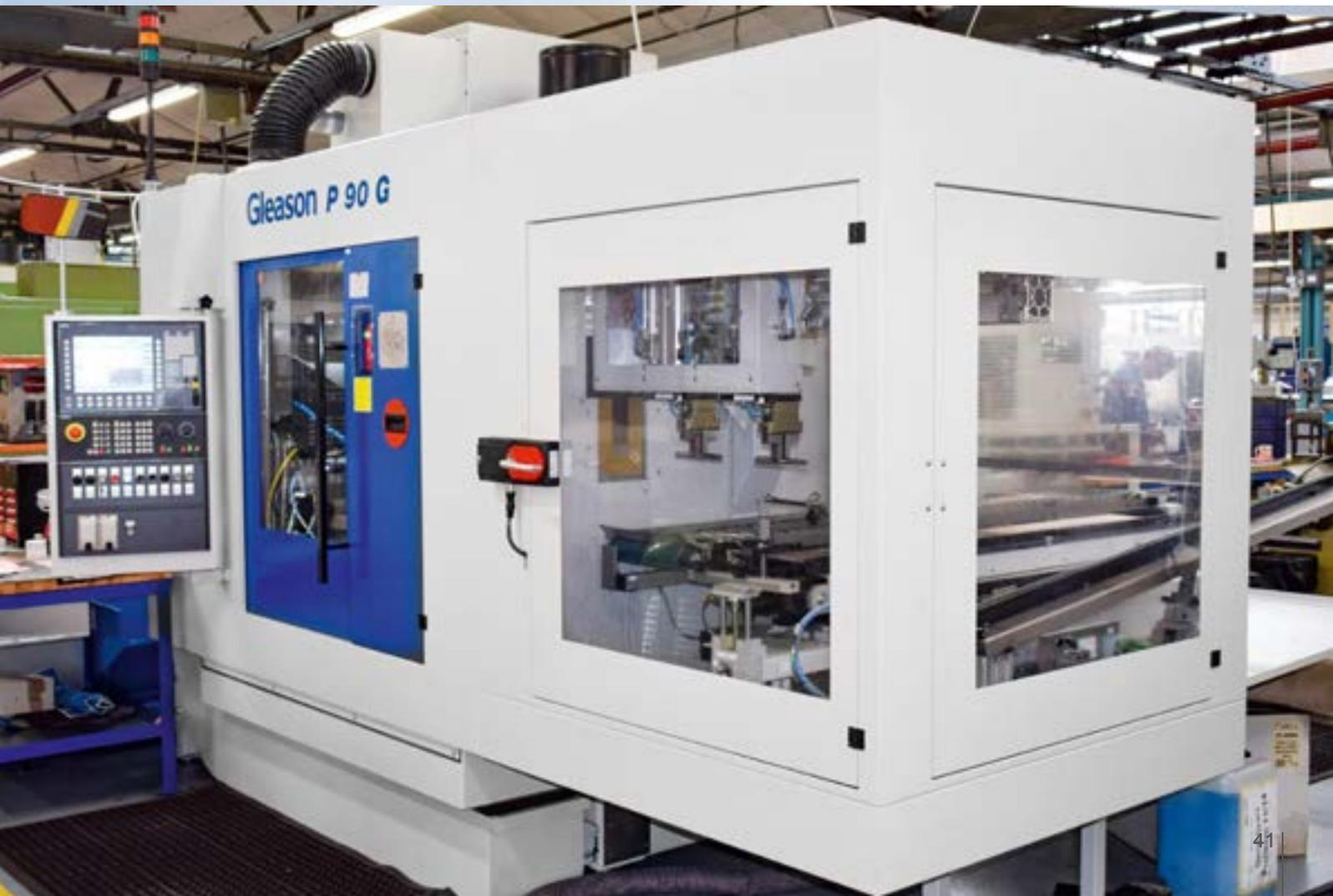
P90G 能滚削和磨削最大模数3毫米，最大直径100毫米的直齿轮、斜齿轮和小齿轮，并向用户提供了三种不同的磨削方法，以涵盖广泛的应用范围：
