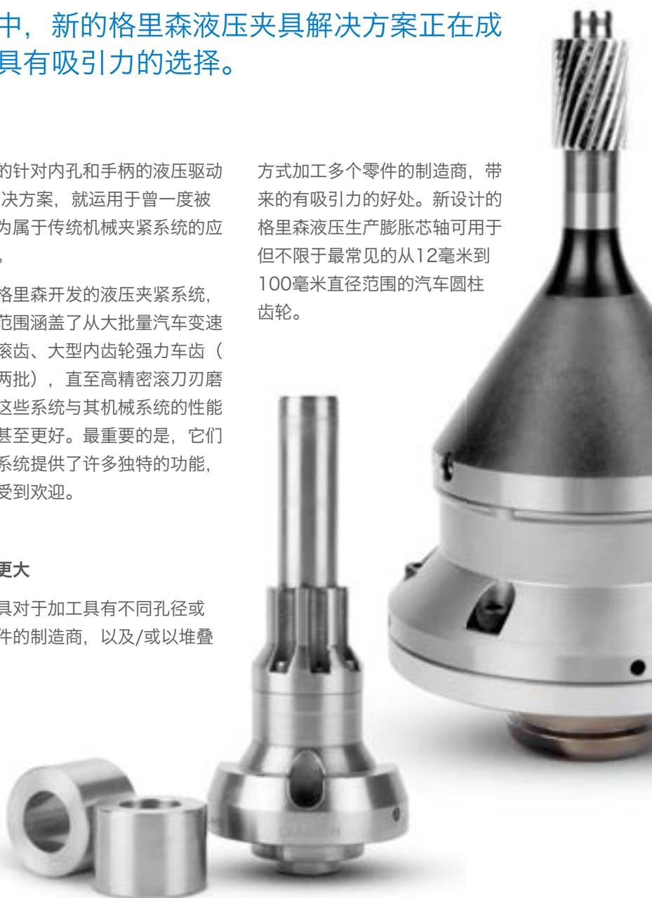
当液压油压力向用硬质工具钢精密加工而成的薄壁膨胀套施加时，会产生强大而持续的夹紧力。套筒根据应用要求在其整个卡紧长度上均匀膨胀。这为单个芯轴提供了固有的灵活性，以满足各种不同孔径零件的要求。
