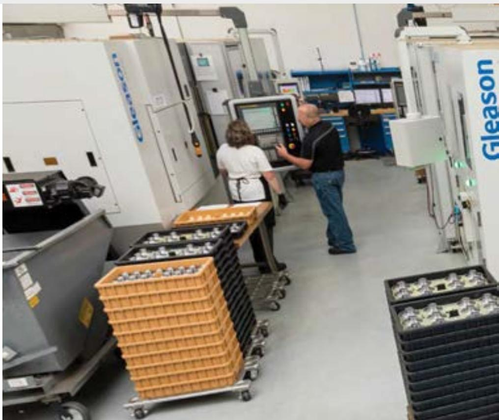
4台格里森280Cs现在做着大约40台手动机器的工作，切割零件 转换时间从一个完整的转换到一个小时左右。
