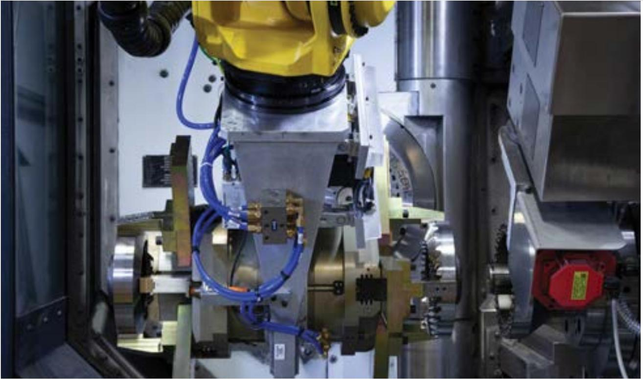
双向机械手末端夹爪工具能使机器人在几秒钟内卸下一个加工完毕的零件，旋转180度，装上一个待加工的毛坯。
