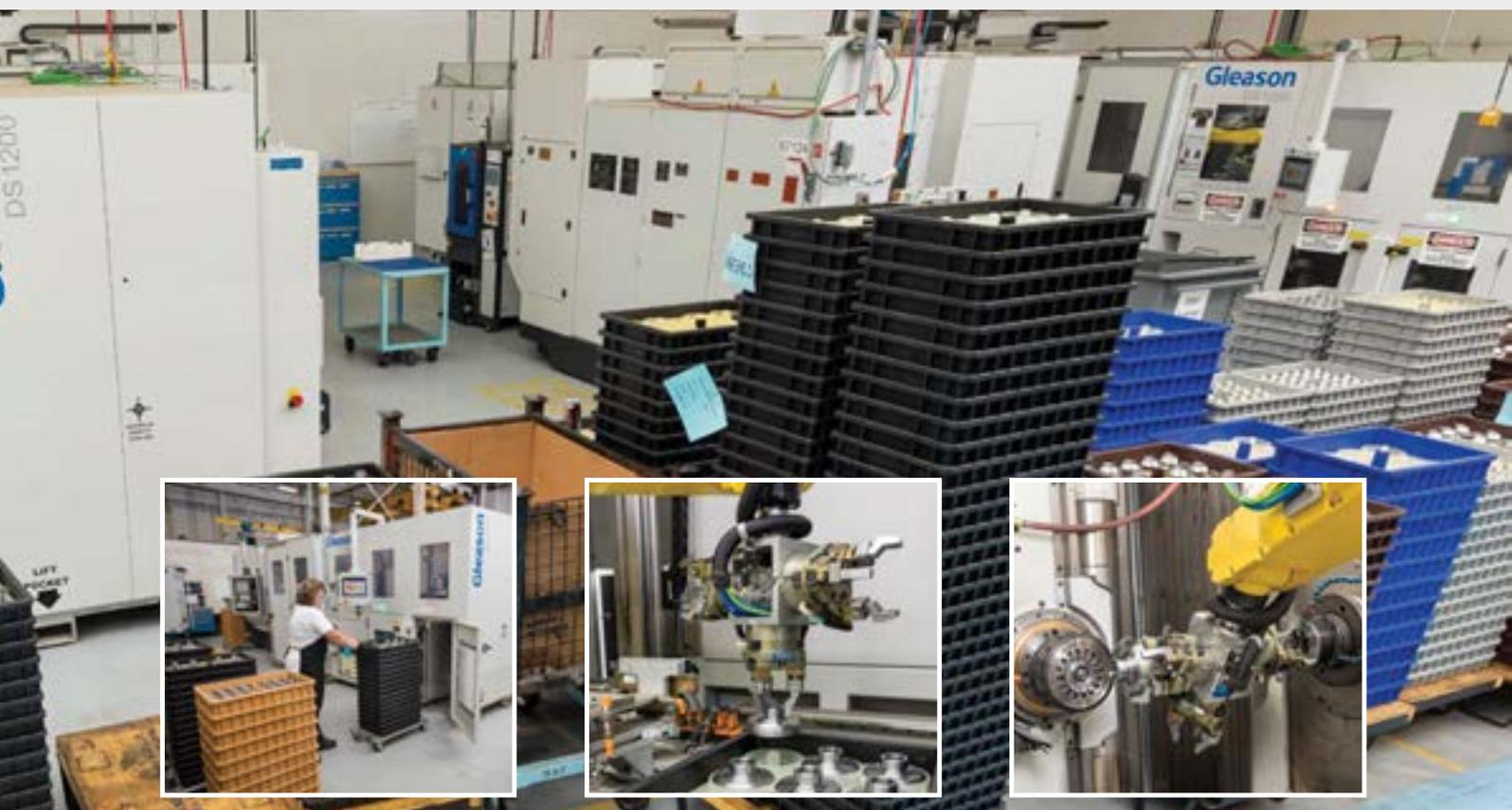
每台 280C 都配有格里森 DS1200 机床装载机构，采用可堆叠托盘系统和机器人来自动装卸零件。与传送机构相比，自动化系统占用空间更少，且在生产过程中能放置更多零件。
