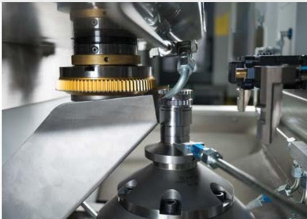
在北美首次安装的 100S 以每分钟3000次的冲程速度，实现了前所未有的快速切削加工。
