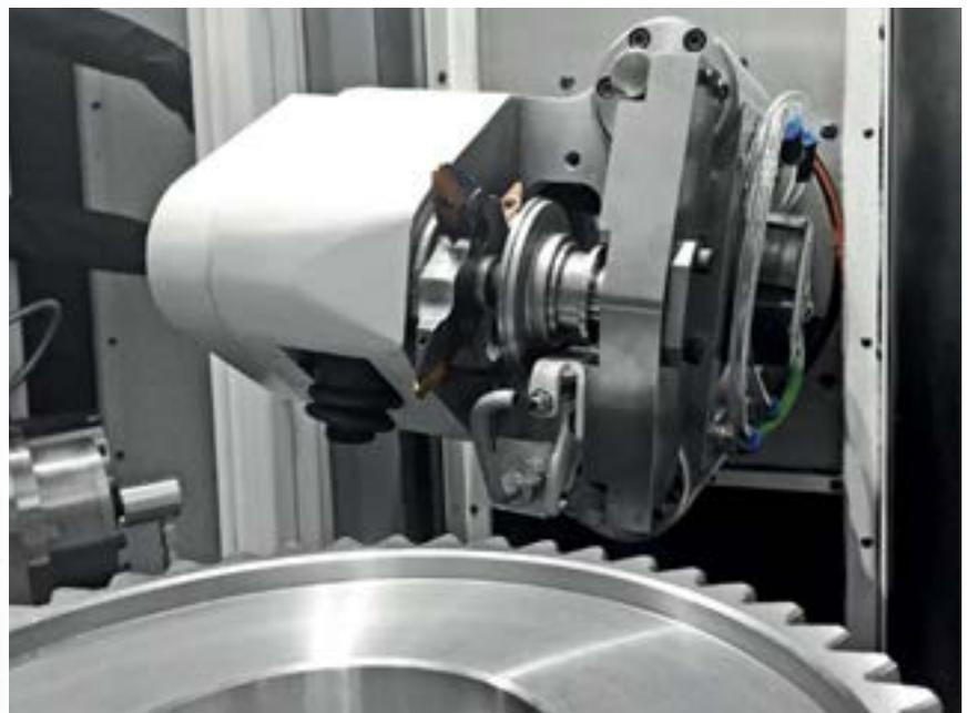
轮廓铣削与滚齿在格里森400HCD机床上平行进行，不增加循环时间，是货车尺寸齿轮的理想选择。
