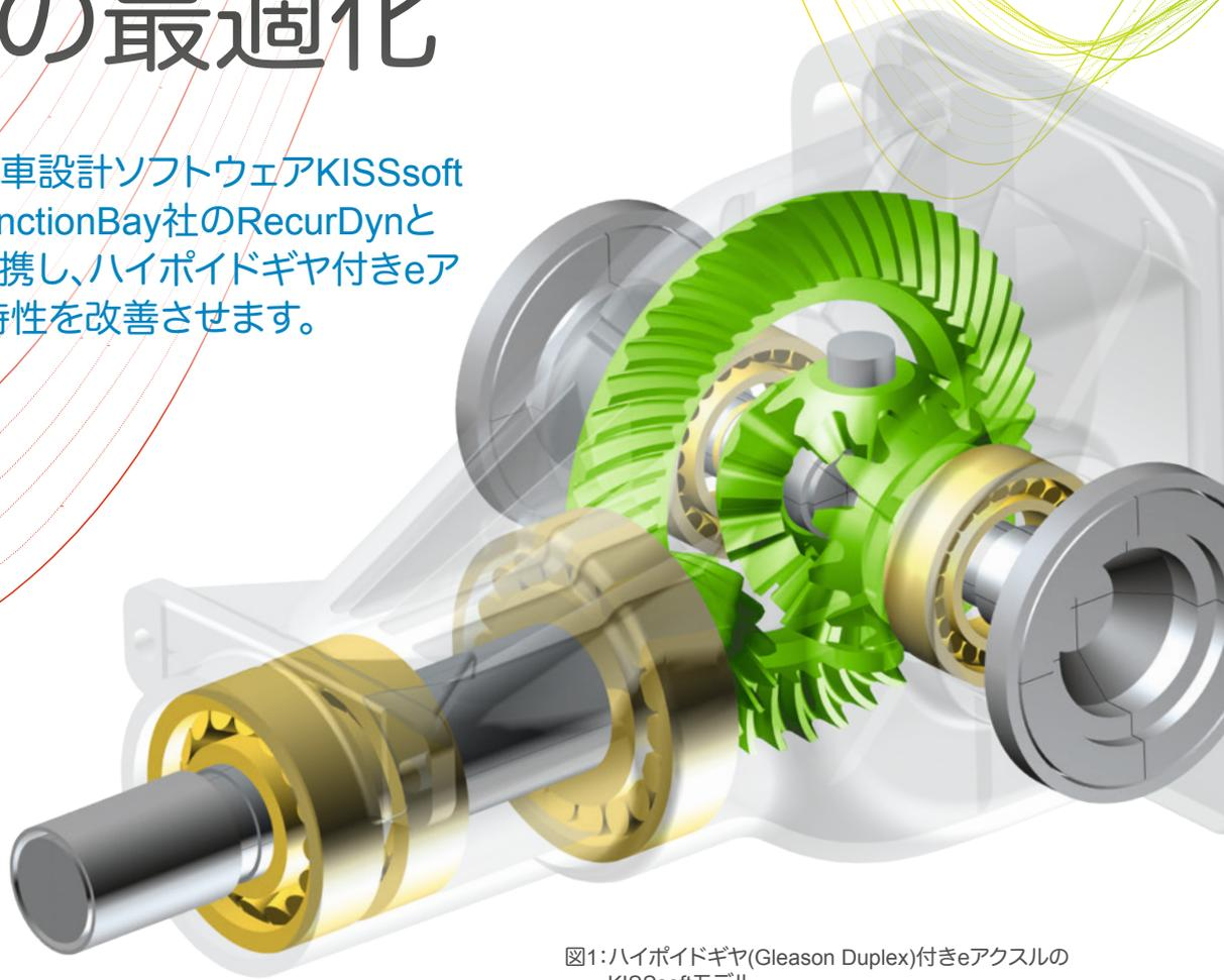
図1:ハイポイドギヤ(Gleason Duplex)付きeアクスルのKISSsoftモデル
