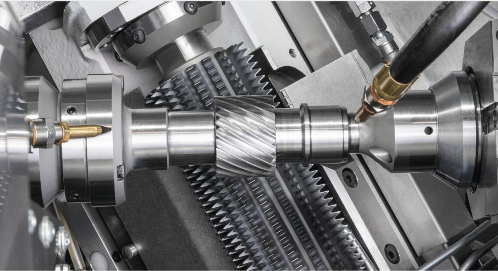
100HCDは、ワーク径120mm、モジュール4、シャフト長450mmまでの幅広いギヤに対応できます。
