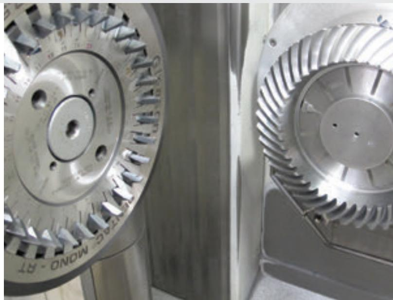
図3: SUPERI-AC Monoの500CBを使用した自動組付けとツルーイング
