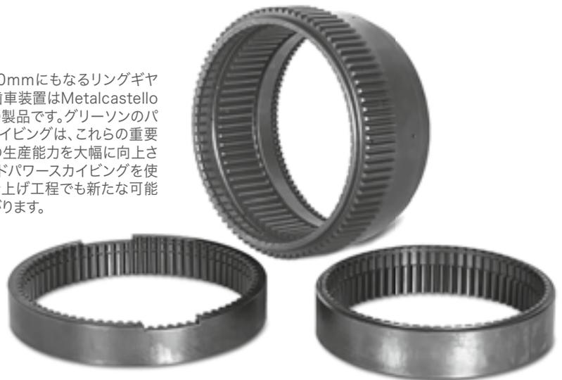
600PSパワースカイピング機は、ギヤシェーパーに比べ4~5倍速いサイクルタイムを達成し、歯車精度を2クラス(DIN等級)向上することに貢献しました。
