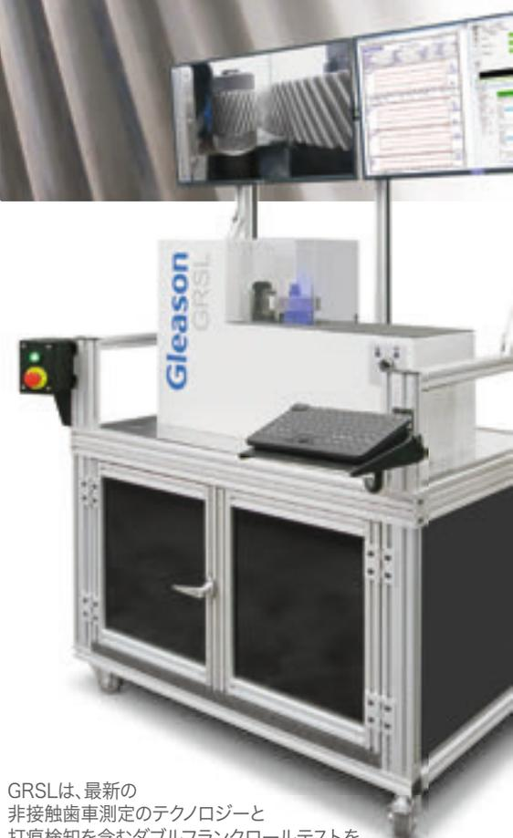
GRSLは、最新の非接触歯車測定テクノロジーと打痕検知を含むダブルフランクロールテストを組み合わせ、外径250mmまでのシリンダリカルギヤ測定にスピーディに対応します。
