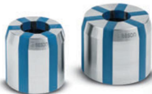
セグメント・コレットは機械のドローロッドがエキスパンダーを引き込むことでコレットが拡張し、強固にワークを保持します。
