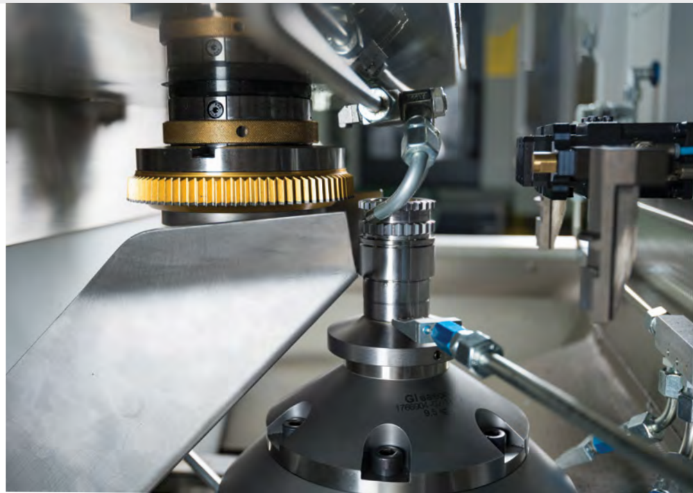
Die erste Installation einer 100S in Nordamerika liefert beispiellose Span-zu-Span-Zeiten mit einer Geschwindigkeit von bis zu 3.000 Hüben pro Minute.
