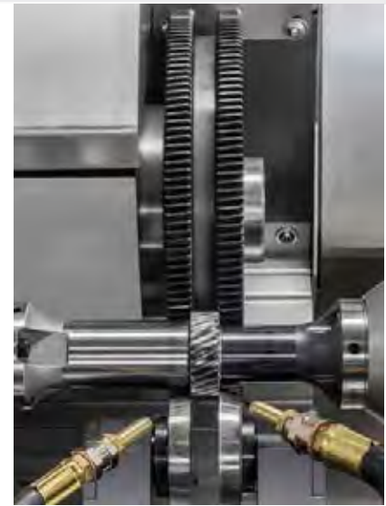
Der Rollanfasprozess erfolgt parallel zum Wälzfräsen auf der Gleason P90CD, einer horizontalen Wälzfräsmaschine.
