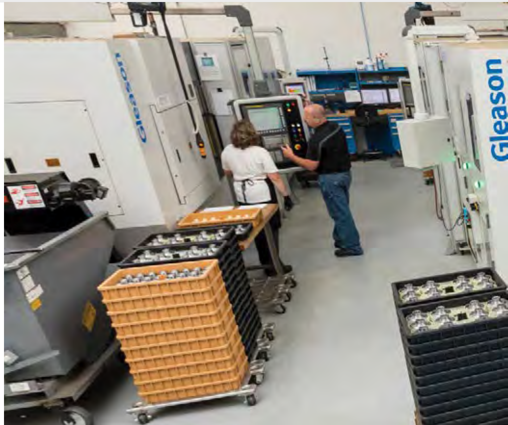
Vier Gleason 280C übernehmen nun die Arbeit von etwa 40 manuellen Maschinen und verkürzen die Umrüstzeit von einer kompletten Schicht auf etwa eine Stunde.
