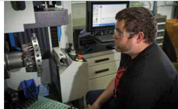
Nachdem der Bediener den Messerkopf eingelegt, Montage- und Messtaster positioniert und die Messer eingeführt hat, kann er sich anderen Arbeiten widmen, während die 500CB Montage, Ausrichtung und Prüfung durchführt.
