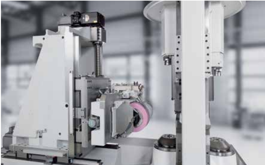
Kurze Leerlaufzeiten dank Doppelspindelkonzept.
