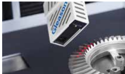
Die Laserabstastung beschleunigt die Entwicklung von immer komplexer werdenden Zahnradern.
