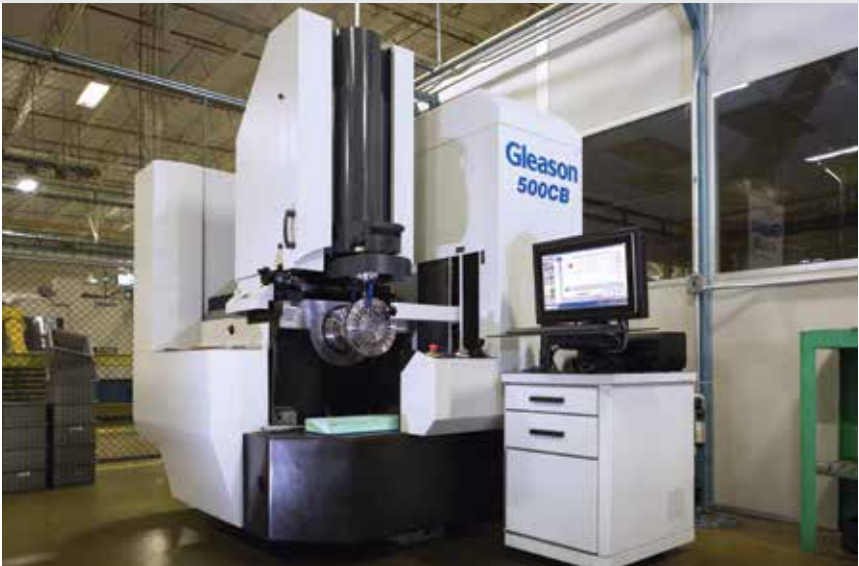
SEW Eurodrive fungierte als Testwerk für die erste 500CB von Gleason. Heute lässt sich damit die Zeit für die Messerkopfmontage von 90 Minuten auf weniger als 30 Minuten reduzieren.
